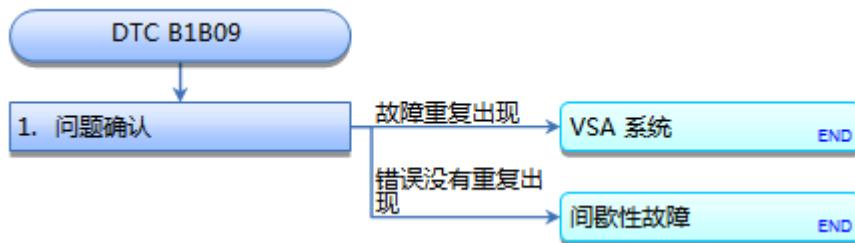
**DTC B1B09:** 来自 VSA 调制器控制器单元的转向角传感器故障信息
